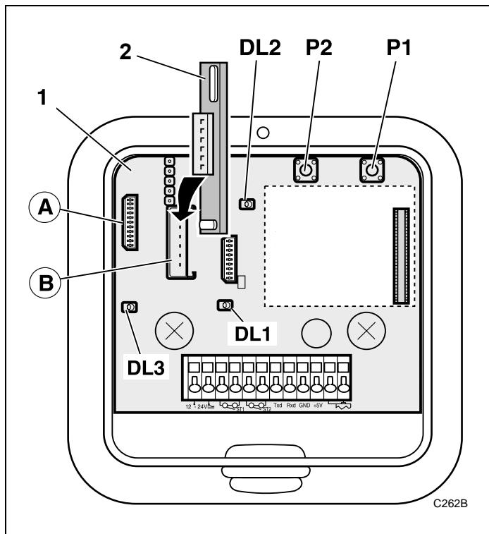
Il est ensuite nécessaire d'enregistrer dans le module LINK-BASE les codes pour ouverture totale (activation Relais 1) et/ou piétonnière (Relais 2). Suivez la séquence suivante :
